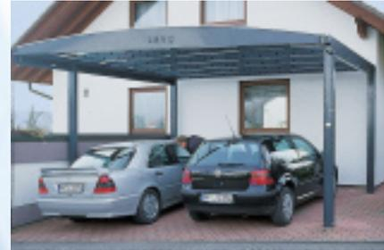
Witterungsbeständige Oberfläche. Verzinktes Stahlblech nach DIN EN 10 326 NA 275 g/qm, ca. 20 µ Zinkauflage und Pulverbeschichtung auf Epoxid-/Polyesterharzbasis, eingebrannt, ca. 80 µ Farbauftrag. Standardfarbe RAL 7016, sofern nichts anderes vereinbart.
