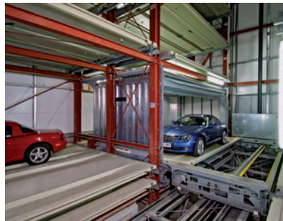
05 Die belegte Parkpalette wird auf das Shuttle gezogen The occupied pallet is pulled onto the shuttle
