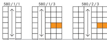
Beim Car Display Tower 580 sind bis zu 3 Parkreihen links und rechts vom Aufzug möglich
